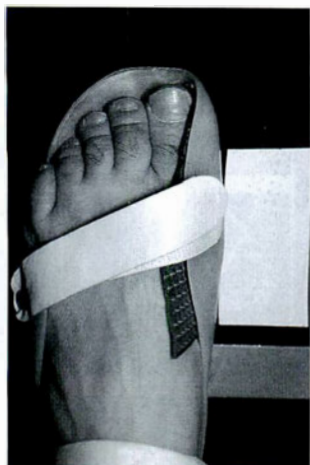
図 11. 超低圧用 prescale と増感度装置のゴムマットを用いて第 1 MTP 関節の内側にかかる圧力の計測
