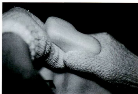
図 7. 加熱した低密度ポリエチレンを当 てて shoe insert を形成する。
